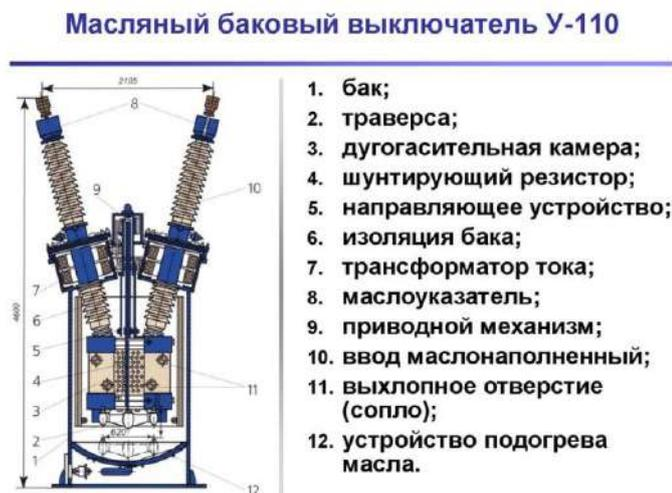
Рис. 1. Строение масляного бакового выключателя типа У-110-2000-50 У1
