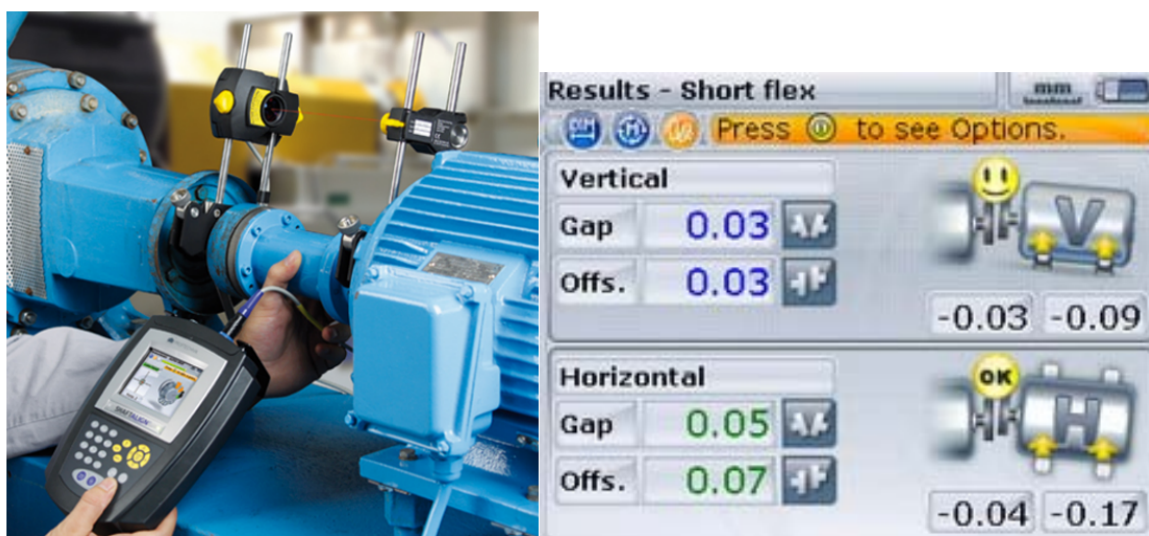
Рисунок 1 – Лазерная установка для контроля соосности валов при монтаже оборудования
