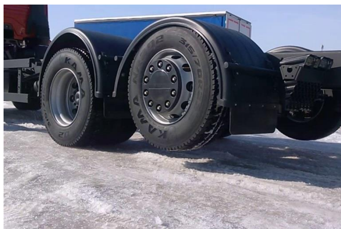
Рисунок 1 – «Ленивая» ось (мост) автомобиля-тягача в поднятом положении
