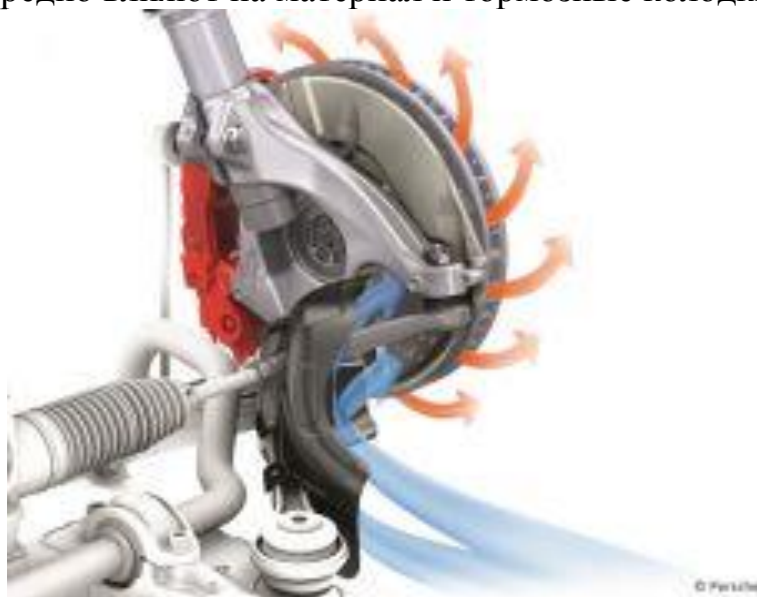
Рисунок 2 – Направление движения воздушных потоков
