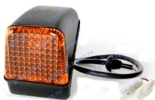
Рисунок 6 – Оборудование седельного тягача и полуприцепа а – габаритный фонарь оранжевого цвета, б – прямоугольник из световозвращающего материала
