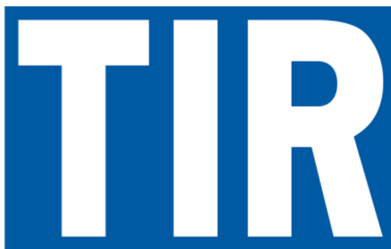
Рисунок 5 – Табличка TIR, размещаемая на транспортном средстве
