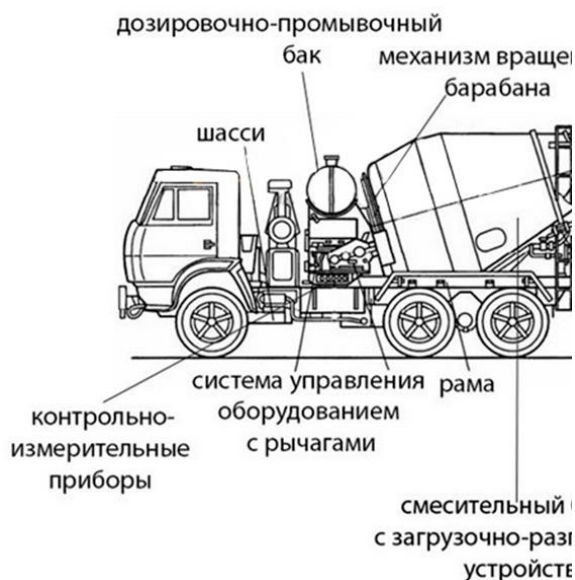
Рисунок 1 – Автобетоносмеситель 58146V (АБС-6К) на шасси КАМАЗ-65111
