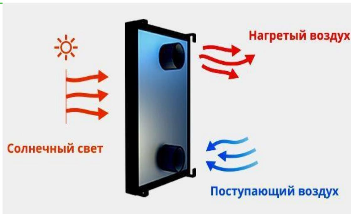
**Рис. 2. Общий вид воздушного коллектора**
