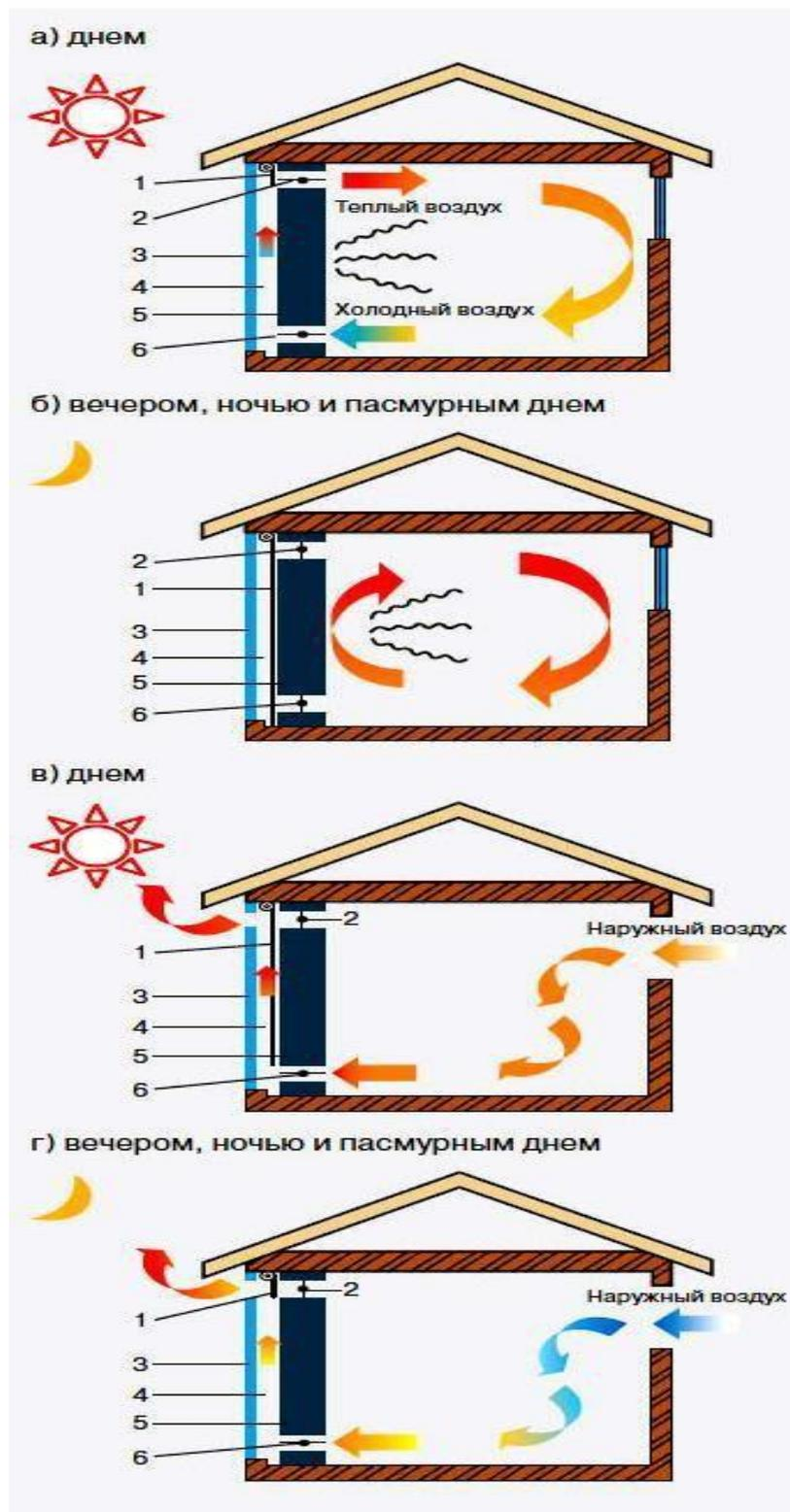
**Рис.1. Схема работы пассивной системы солнечного отопления**
