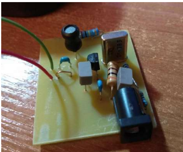
Рис. 3. Кварцевый генератор на 6,5 МГц после сборки
