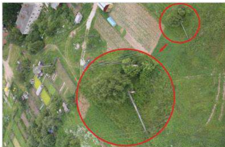
Рис. 2. Упавшая опора, зафиксированная Птеро-G0
