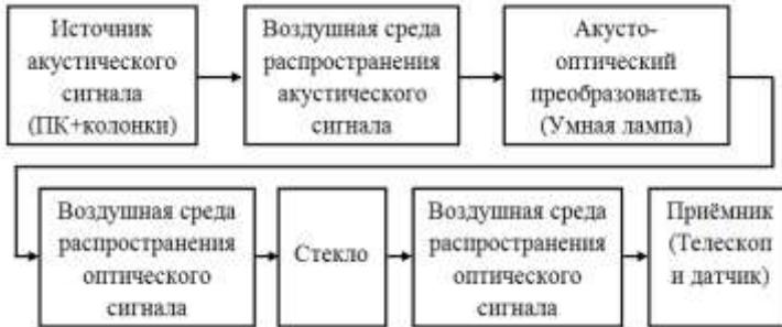
Рис. 2. Структура нового технического канала утечки информации
