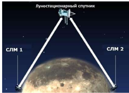
Рис. 1. Измерение углов со спутника на световые лазерные маяки
