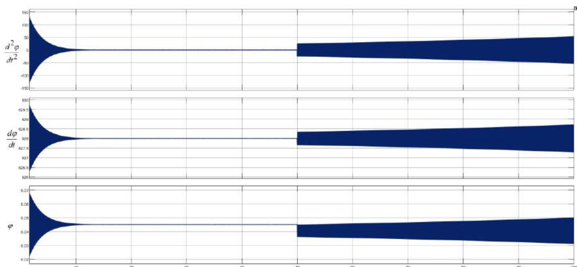
Рис. 1. Переходный процесс при сбросе нагрузки 10 % от начальной в момент времени t = 50 с без оптимального регулятора
