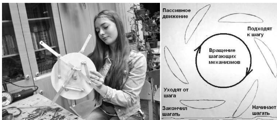
Общий вид и принцип действия колеса с шагающими механизмами
