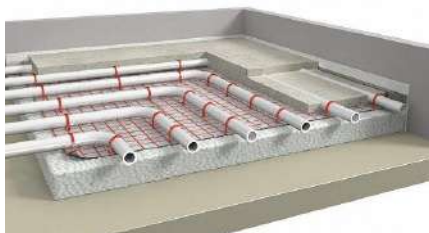
Рис. 2. Монтаж теплого пола
