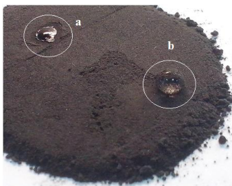
Рис. 2 - Взаимодействие уплотненного слоя ТКШ 450 с нефтью (a) и водой (b)
