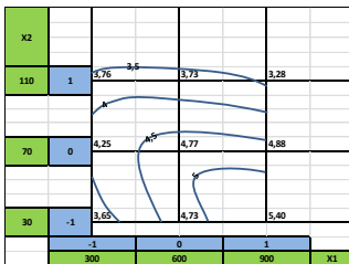
Рис. 1. Графическая модель влияния длины и времени на износ дорожного покрытия из порфирита
