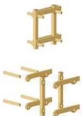
Рис. 3 Узловое соединение ригеля и колонны, используемое в здании TAMEDIA центра
