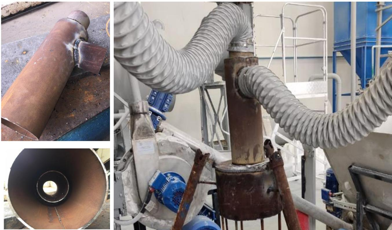
**Рис. 12. Изготовление, апробация и использование классификатора с соосно расположенными трубами на предприятии**
