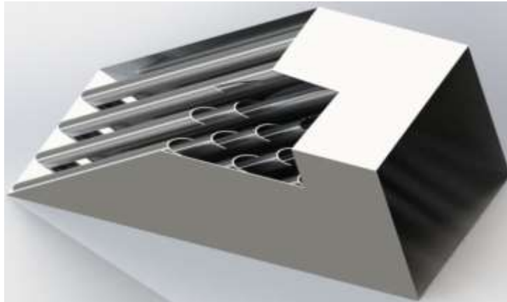
Рис. 1. Трехмерная модель сепаратора (вид с разрезом). Движение газовых выбросов происходит справа налево Fig. 1. 3-D model of a separator (sectional view). Gas emissions move from right to left
