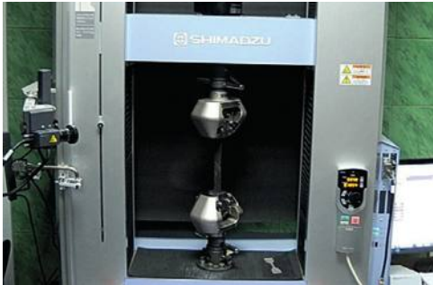
Рис.2 Машина для проведения испытаний на растяжение, сжатие или изгиб
