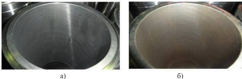
Рис.3 Гильза до (а) и после (б) латунирования
