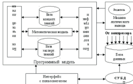
Рисунок 1 - Высокоуровневая структурная схема экспертной системы
