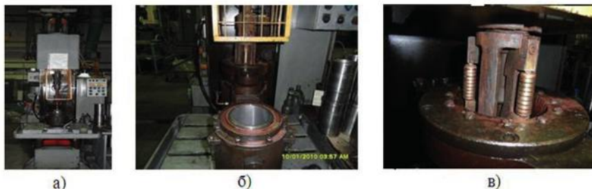
Рис. 4 Процесс латунирования на хонинговальном станке СС6101, переоборудованном для процесса латунирования гильз цилиндров (а), приспособление для установки гильзы (б), хонинговальная головка с установленными роликами для латунирования гильз цилиндров (в)
