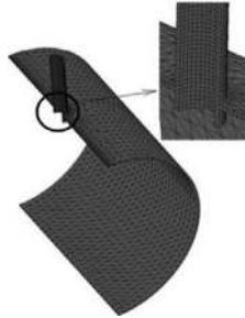
Рис.2 Сетка соединения штуцера с обечайкой
