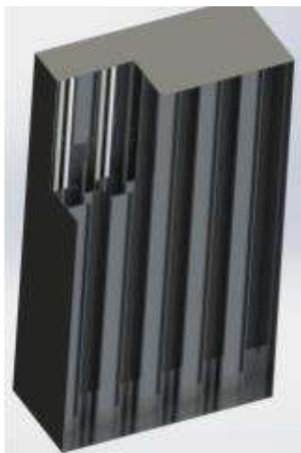
3D модель прямоугольного сепаратора (вид в разрезе)
