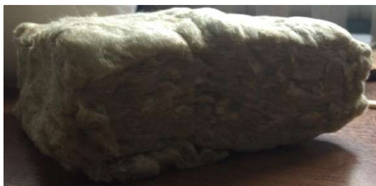
Рис. 2 . Образец материала Rockwool TexMat 50 в сухом виде
