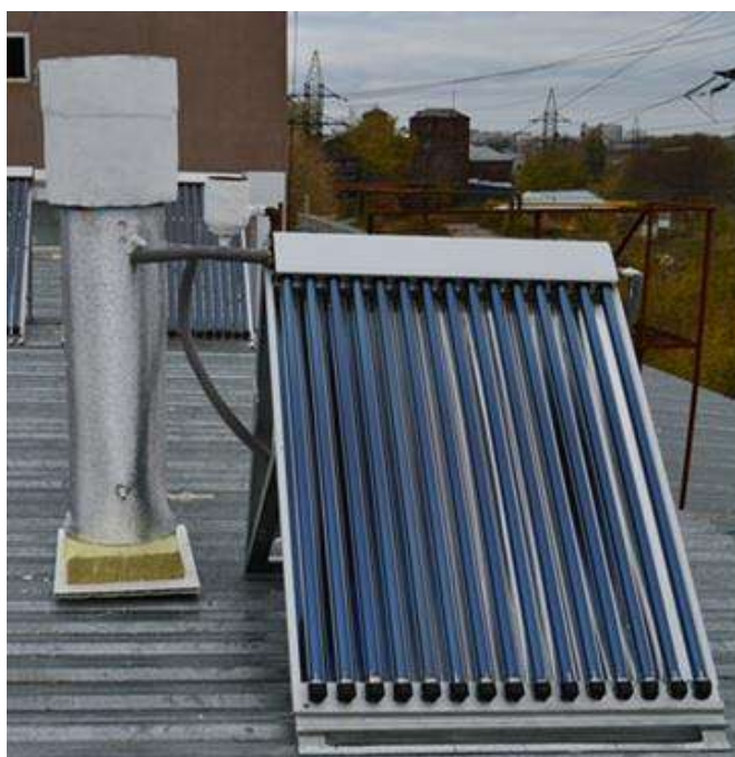
Рис. 1. Общий вид опытной автономной опреснительной установки морской воды паровоздушного типа
