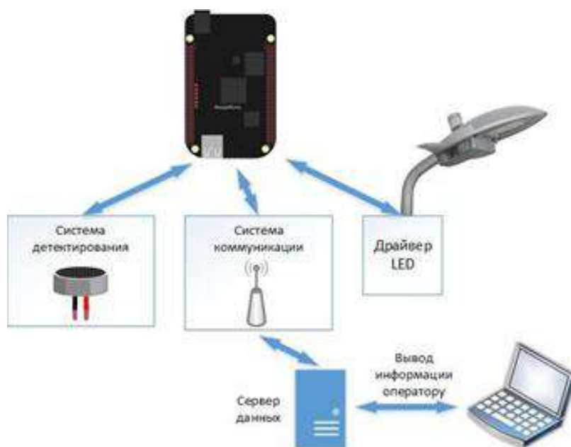
Рис. 1. Реализация концепции интеллектуальной системы освещения
