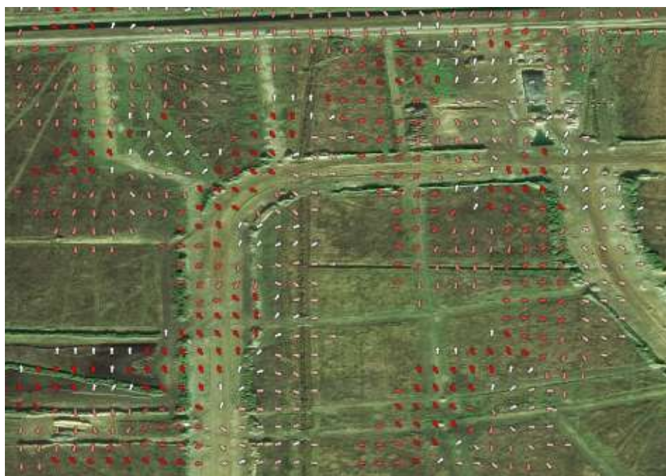
Рис 2. Пример визуализации поверхностного стока по цифровой модели рельефа с наложением на спутниковый снимок высокого разрешения. Стрелками указано направление стока, цветом визуализирована интенсивность стока. Хорошо видны области аккумуляции поверхностного стока.
