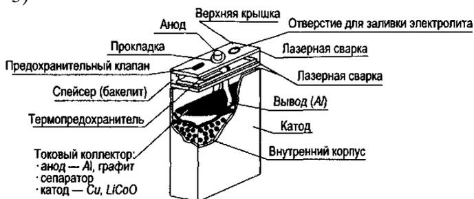
Рисунок 1 – Конструкция Литий ионного аккумулятора
