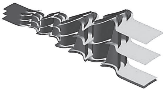
Рис. 1. Результаты численного исследования течения газа в проточной части ГТ
