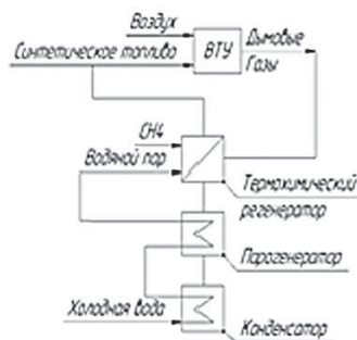
Рис. 1. Принципиальная схема ТХР с конденсатором
