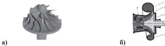
Рис. 1. а) Модуль рабочего колеса; б) Конструкция направляющего аппарата и турбины детандера: 1 — улитка, 2 — рабочее колесо, 3 — выходной диффузор, 4 — продольное ребро, а — кольцевой канал.
