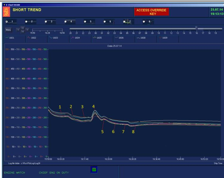
Рис.4 График кривых изменения значений температуры выпускных газов ДВС при изменении условий внешней среды.
