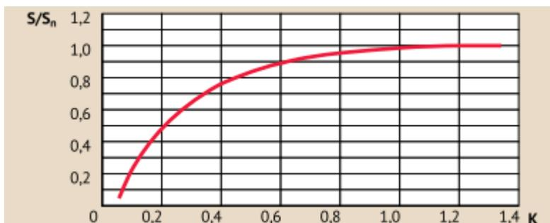
Рис. 5. Зависимость расстояния срабатывания от площади реального объекта воздействия
