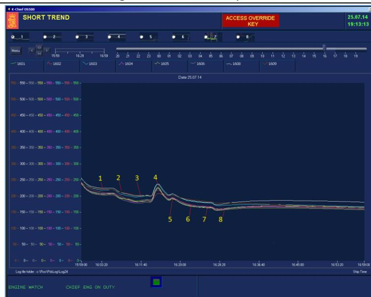
Рис.4 График кривых изменения значений температуры выпускных газов ДВС при изменении условий внешней среды.
