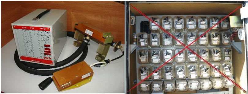
Рисунок 1 – Замена электромагнитных реле современной микропроцессорной элементной базой
