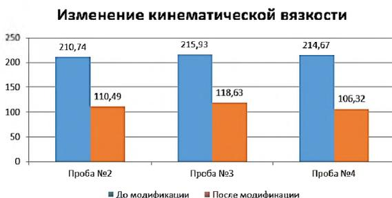
Рис. 2. Диаграмма изменения кинематической вязкости образцов № 2, 3, 4
