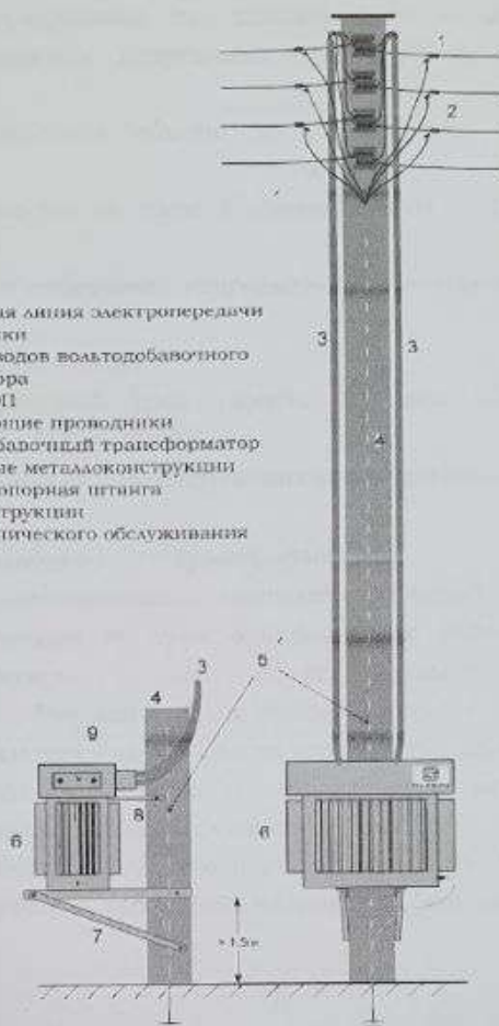
Рис. 1 Монтаж вольтодобавочного трансформатора на опору ЛЭП
