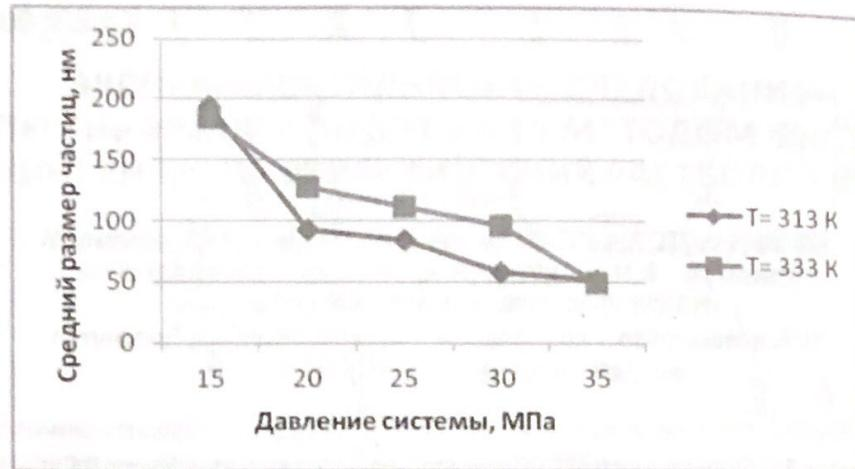
Рисунок 2 -Зависимость среднего размера частиц от давления.
