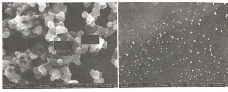
Рисунок 3 - Изображение частиц лидокаина при давление в системе Р= 15 МПа, при температуре насытителя Т= 313 К. а)необработанные, б) после измельчения методом RESS
