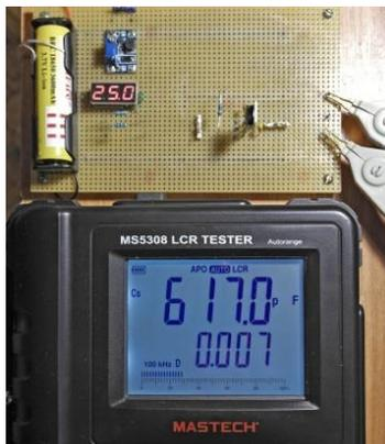
Рис. 11. Процесс измерения входной емкости мощного МОП-транзистора
