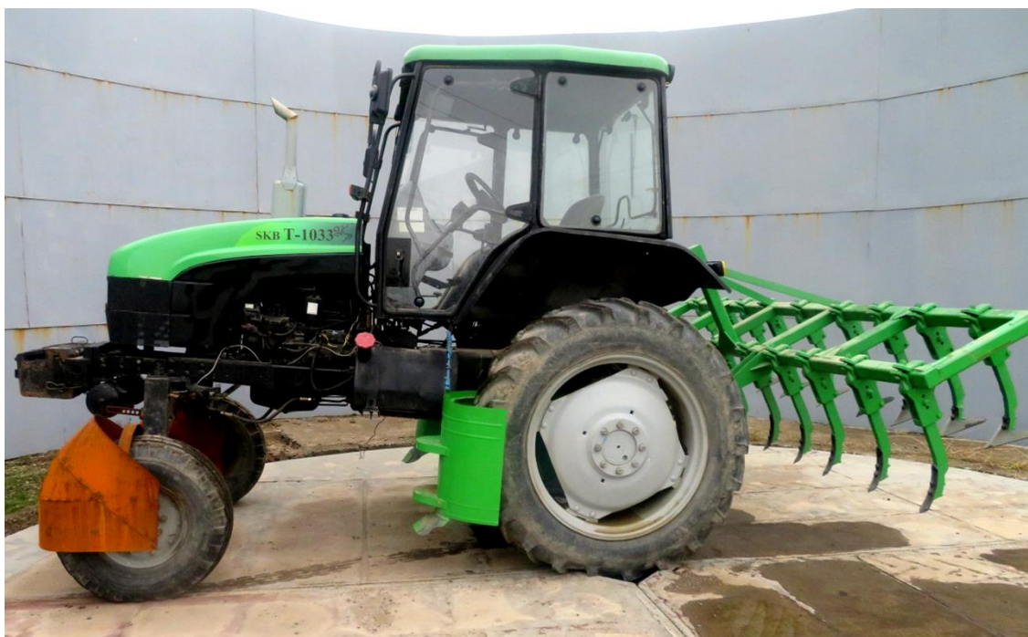
Рис. 1. Трактор ТТЗ-1033 в агрегате с навесным чизелем-культиватором ЧК-3,0 (вид сбоку)
