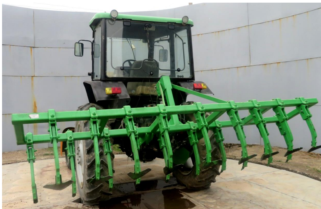
Рис. 2. Трактор ТТЗ-1033 в агрегате с навесным чизелем-культиватором ЧК-3,0 (вид сзади)
