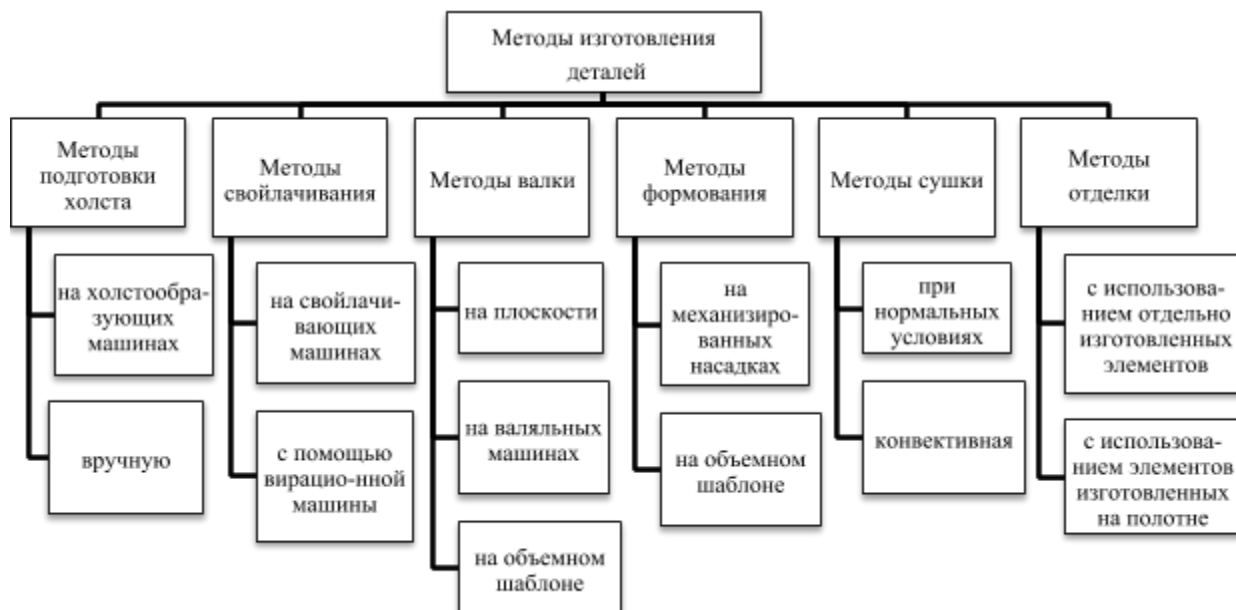
Рис. 2. Методы изготовления деталей одежды объемной формы из войлока
