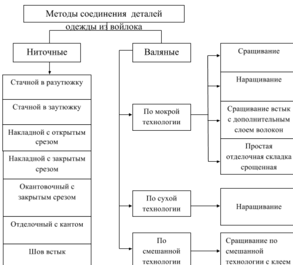
Рис. 1. Методы соединений и швы в изделиях из войлока
