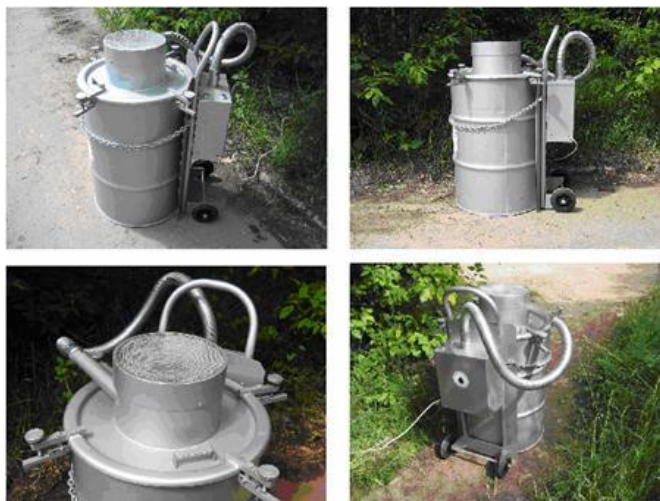
Рис. 3. Установка по сжиганию органических отходов «Форсаж-1»
