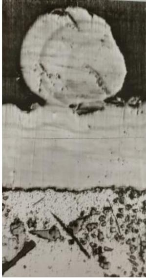
Рисунок 3 – Бимодальная структура газофазного хромового покрытия ( $t_{\text{н}}=450^{\circ}\text{C}$ ;  $P=1040$  Па;  $t_{\text{и}}=280^{\circ}\text{C}$ ;  $\tau=30$  мин)
