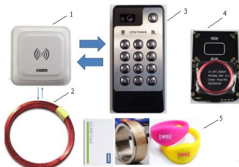
Рисунок 1 – «HandsFree» модуль для домофона.1- внешний модуль «HandsFree» (1-ая модификация), 2-внешняя антенна для модуля «HandsFree», 3-домофонная система,4-модуль «HandsFree» встраиваемый в домофон (2-ая модификация)
