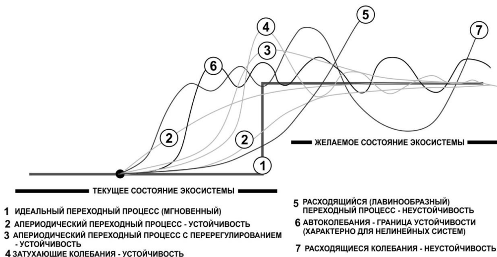
Рис. 3. Переходные процессы в простейшей системе управления
