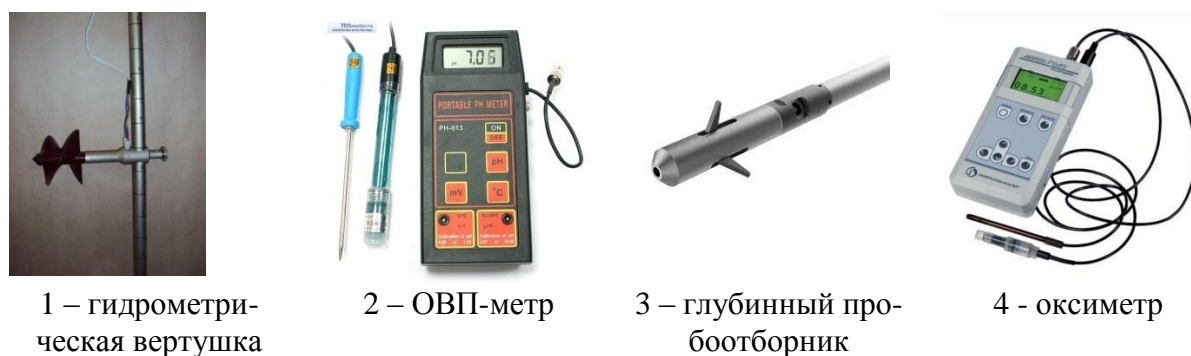
Рис. 1. Приборы и оборудование для проведения исследования
