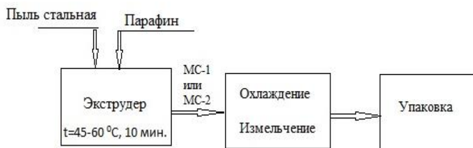
Рис. 3. Технологическая схема получения магнитосорбентов
