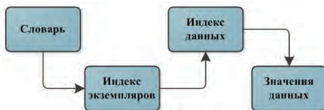
Рис. 1 Компоненты систем полностью инвертированных файлов
