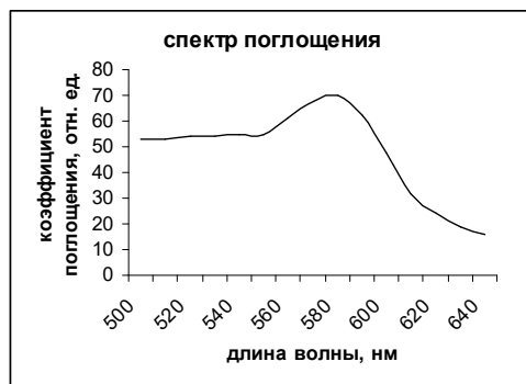
Рисунок 1 - Спектр оптического поглощения наночастиц меди в стекле G1
