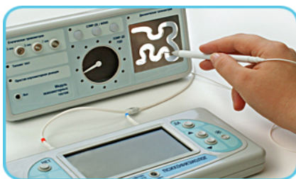
Рисунок 2 – Устройство психофизиологического тестирования УПФТ-1/30 «Психофизиолог»
