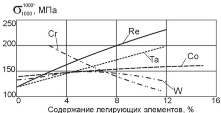
Рисунок 2 - Влияние содержания легирующих элементов на длительную прочность
