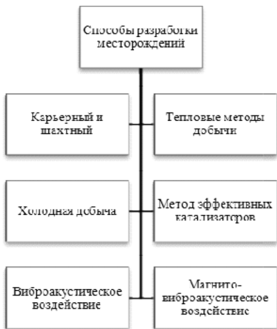
Рисунок 1 – Основные способы разработки месторождений высоковязкой нефти
