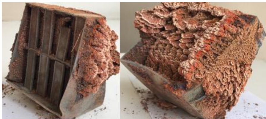
Рис. 2. Прямоугольный сепаратор после проведения эксперимента в очистительном цикле (изображение слева – входной патрубок, изображение справа – выходной патрубок)
