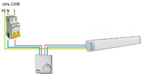
Рис. 1. Устройство электронного инфракрасного нагревателя
