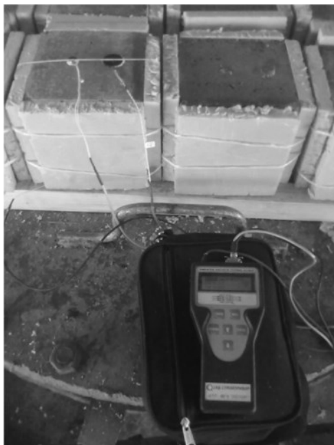
Рис. 2. Установка для измерения плотности тепловых потоков
