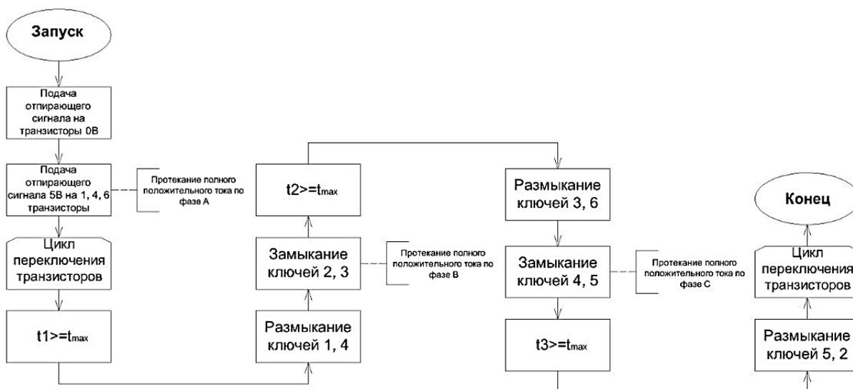
Рис. 2. Алгоритм управления инвертором
