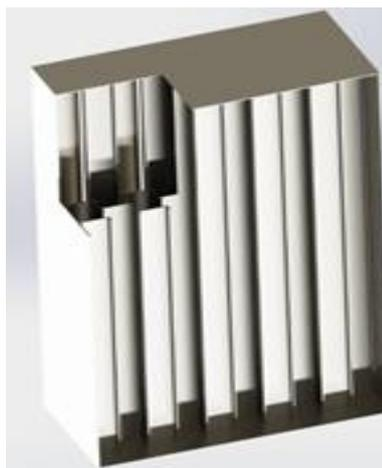
Рис. 1. Трехмерная модель прямоугольного сепаратора
