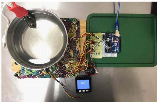
Рис. 5. Установка для тестирования датчиков температуры
