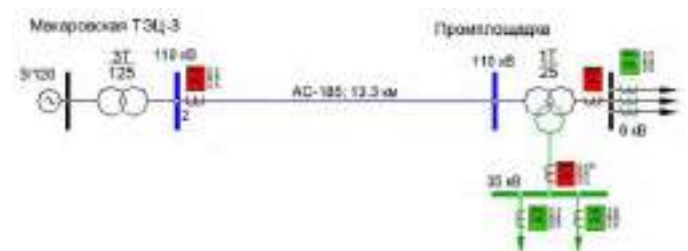
Рис. 2 - Схема расстановки измерительных комплексов коммерческого и технического учёта электроэнергии в исследуемой электрической сети: красный – коммерческий, зелёный – технический учёт электроэнергии
