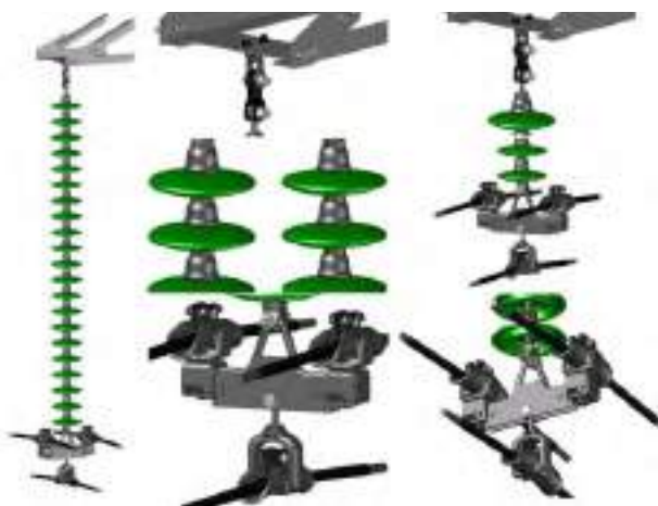
Рис. 6 – Восстановленная 3D модель линейной гирлянды ВЛ 500 кВ, устанавливаемой на промежуточных опорах 500 кВ
