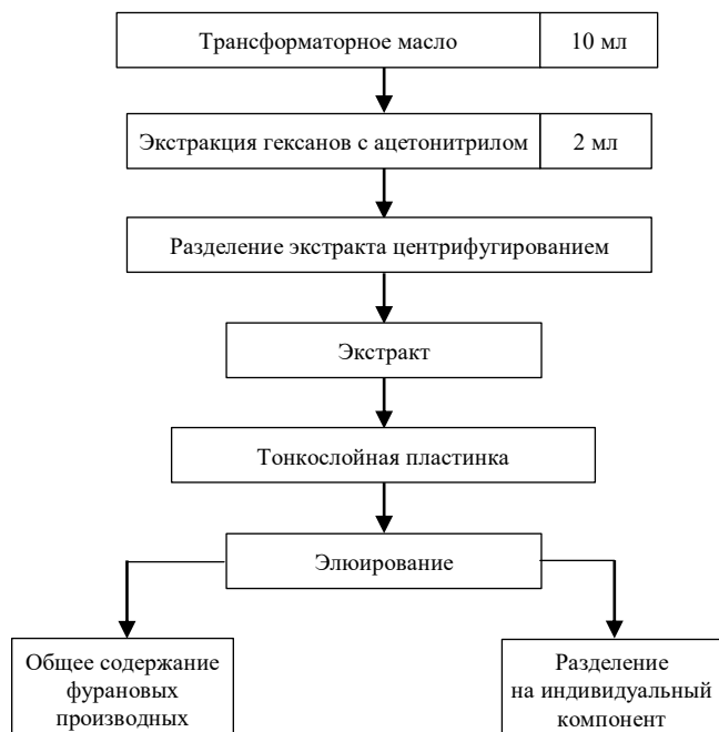
Рис. 1 – Алгоритм определения фурановых производных в трансформаторном масле
