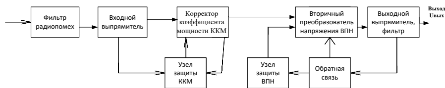
Рис. 2 – Структура электронных блоков питания и преобразователей ЭДМ
