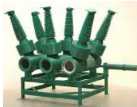
Рис. 6 – Напечатанная и собранная модель выключателя ВЭБ-110 в масштабе 1/10 (высота 130 мм, ширина 250 мм)
