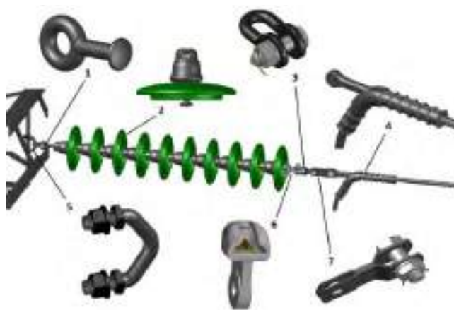
Рис. 5 – Элементная база линейной арматуры и изоляции. Пример гирлянды ошиновки с портала ОРУ 110 кВ, выполненной на основе арматуры GIG с проводом АС-240: 1 – серьги типа СРС-7-16; 2 – изолятор стеклянный линейный подвесной тарельчатый П-70; 3 – скобы типов СК-7-1А; 4 – зажимы натяжные прессуемые типа НАС-330-1Б; 5 – узел крепления КГП-7-3; 6 – ушко однолапчатое типа У1К-7-16; 7 – звенья промежуточные трехлапчатые типа ПРТ-7/12-2
