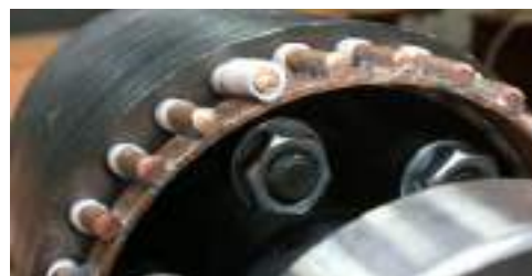
Рис. 2 – Ротор АД с оборванным стержнем
