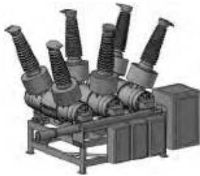
Рис. 5 – Восстановленная методом обратного инжиниринга САД-модель выключателя ВЭБ-110
