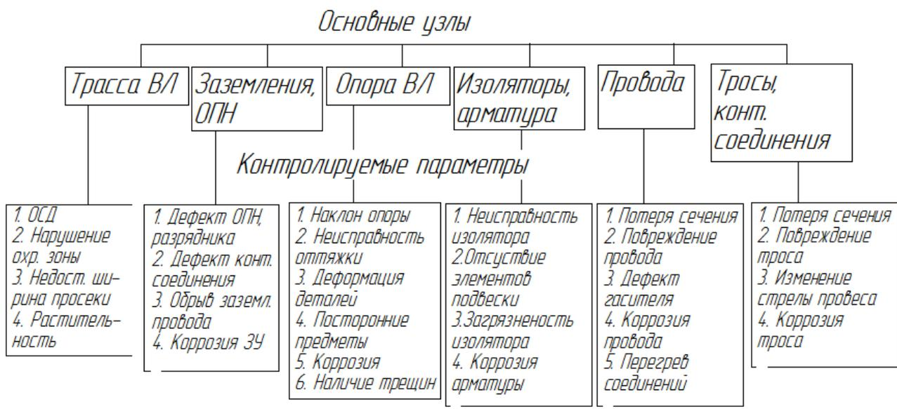
Рисунок 2. Контролируемые параметры ЛЭП
