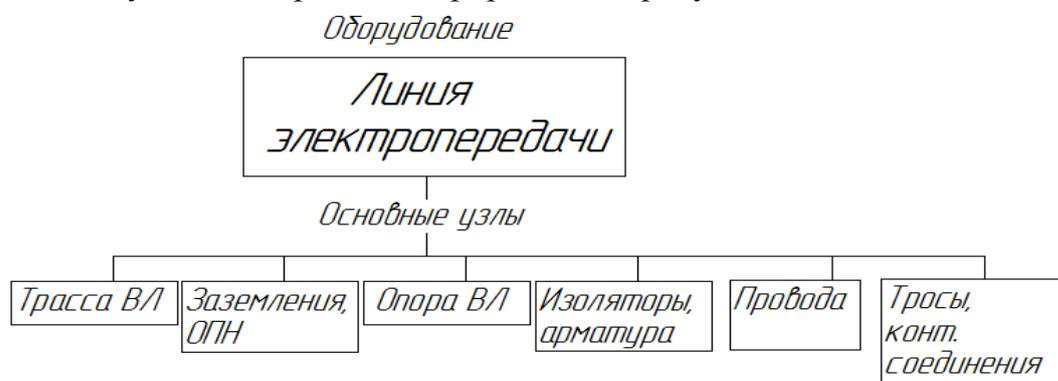
Рисунок 1. Узлы оборудования
