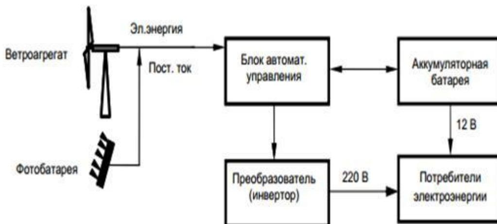
Рисунок 2. Автономная энергосистема на основе ВИЭ
