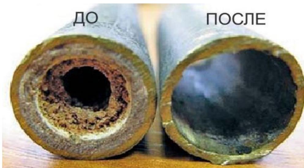
Рис. 1. Состояние трубы до и после промывки.
