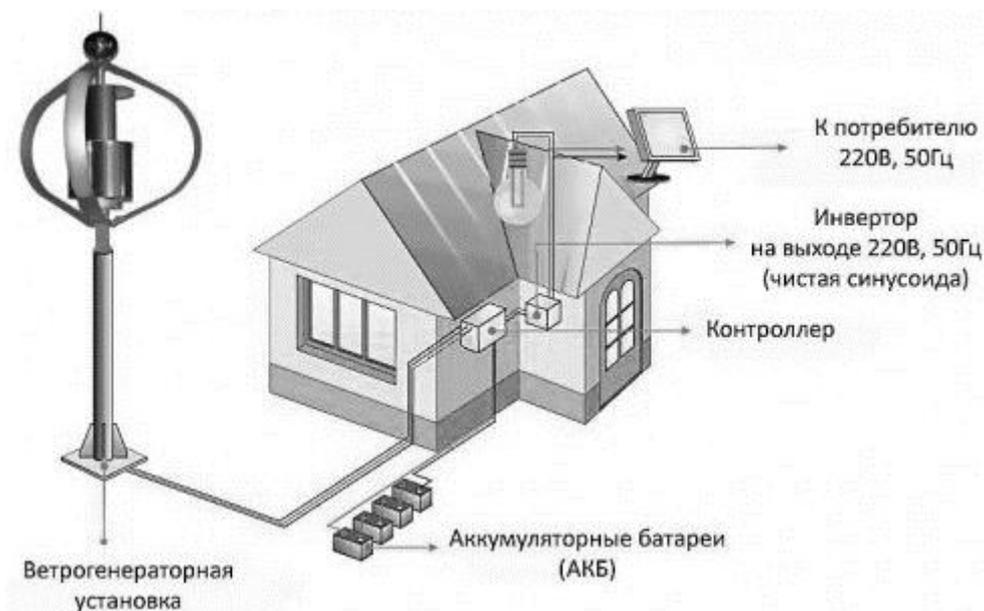
Рисунок 1. Полностью автономная система
