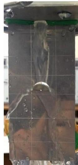
Рис. 2 – Движение жидкости по пластине с одним лепестком
