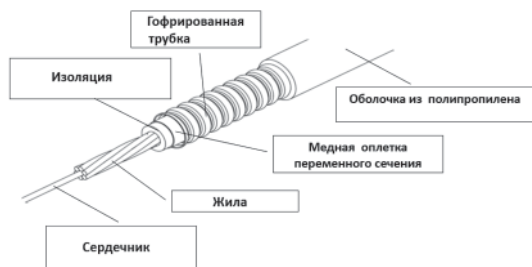
Рис. 1. Индукционно-резистивный гофрированный кабель
