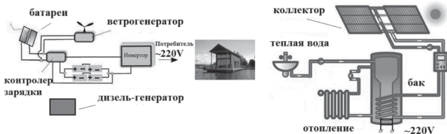
Рис. 1. Схема системы электроснабжения и теплоснабжения дома
