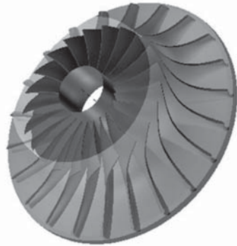
Рис. 1. Модель рабочего колеса центробежной радиально-осевой турбины
