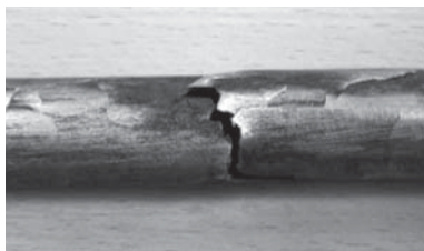
Рис. 1. Поврежденная трубка ПСГ-5000
