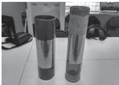
Рис. 1. Обмотки сверхпроводящего понижающего трансформатора: слева — первичная; справа — вторичная
