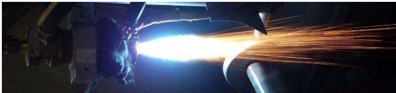
Рисунок 1 – Процесс воздушно-плазменного нанесения покрытий
