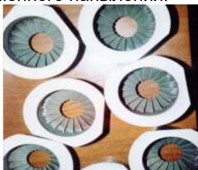
Рисунок 7 – Детали газовой турбины ГТН-25 с теплозащитным покрытием из диоксида циркония
