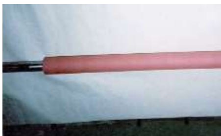
Рисунок 4 – Вал типографской машины с медным покрытием
