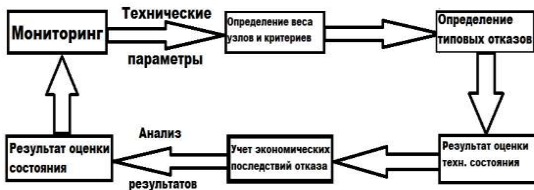
Рисунок 1 - Комплексный метод оценки технического состояния электрооборудования
