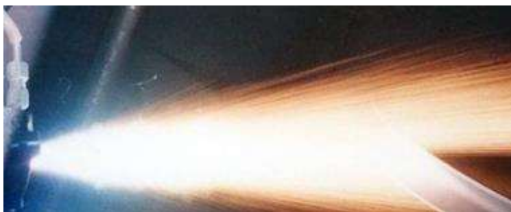
Рисунок 2 – Процесс напыления износостойкого покрытия на поверхность валка стана вытяжки проволоки
