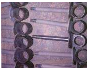
Рисунок 3 – Штоки гидронасосов с износостойким покрытием
