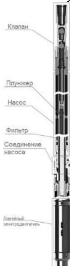
Рисунок 1 – Структура погружного насосного устройства
