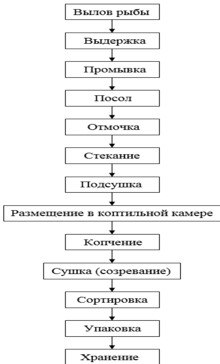
Рисунок 1. Частная технологическая схема производства рыбы холодного копчения (пеляди весом 200...220 г)
