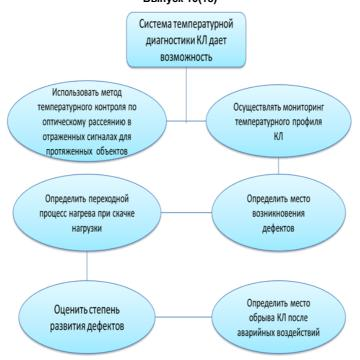
Рисунок 2 – Функции температурного мониторинга DTS
