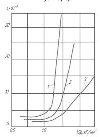
Рис. 2. Зависимость интенсивности линейного износа от удельной нагрузки: 1— для отожженной поверхности; 2— для поверхности, обработанной твердосплавным инструментом; 3— для поверхности, обработанной минералокерамическим инструментом
