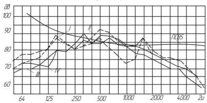
Рис. 1 График спектра шума зубчатых передач обоих видов в зацепления с M=4,5 мм,  $z_1=19$ ,  $z_2=80$  после их обкатки в течение 2 ч.
