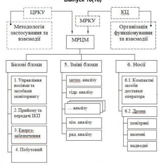
Рис. 2. Організаційна схема мобільного регіонального центру моніторингу у передумовах НС.
