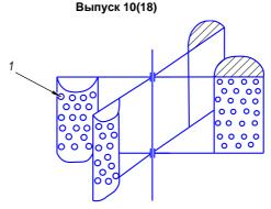
Рис. 1. Вітродвигун з вертикальною віссю обертання та аеровентилями R- аеровентиль
