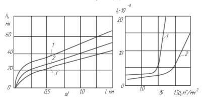
Рис. 1. а — зависимость линейного износа от пути трения: 1 — для отожженной поверхности; 2 — для поверхности, обработанной твердосплавным инструментом, 3— для. поверхности, обработанной минералокеоамичсским инструментом; б — зависимость интенсивности линейного износа от удельной нагрузки: 1 — для поверхности, обработанной твердосплавным инструментом, 2 — для поверхности, обработанной мпнералокерамнчоским инструментом
