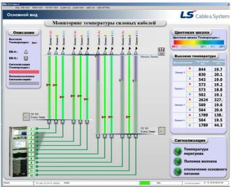
Рисунок 5 – Основной вид системы мониторинга DTS для ПС «RS»
