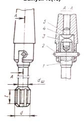
Рис. 1. Развёртка с цилиндрическим хвостовиком, закреплённая в патроне державке.
