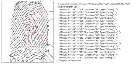
Рисунок 2 – Отримання цифрового шаблону відпечатка пальця
