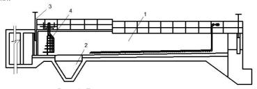
Рис. 1. Горизонтальная песколовка:
