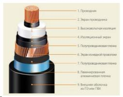
Рисунок 4 – Кабель с медным проволочным экраном марки OP-CWSLAE-W
