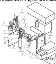
Рис.1. Устройство для автоматической смены инструмента
