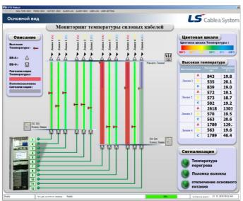
Рисунок 7 – Основной вид системы мониторинга DTS для ПС «RS» при повышении температуры в КЛ
