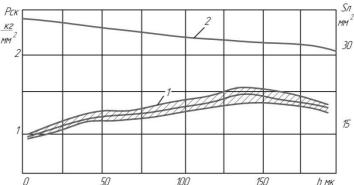
Рис.4. Зависимость критического давления (кривая 1) и площади лунки (кривая 2) от глубины наклепа.
