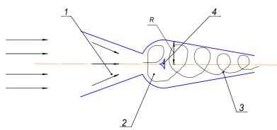
Рис.4. Перетворення ламінарного потоку повітря у вихровий (спіралевидний)
