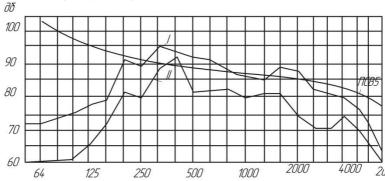
Рис. 2 Кривые спектра шума для двух зубчатых передач с различными профилями зацепления. с m=4 мм.  $z_1=27$  и  $z_2=43$  (при n=1470 о 6/мин).
