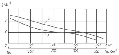
Рис.3. Зависимость интенсивности линейного износа 1-от глубины h наклепа, 2- от микротвёрдости H.
