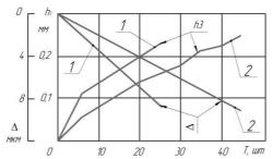
Рис. 3. Зависимости износа hз, по задней поверхности и  $\Delta$  по диаметру стандартных (кривые 1) и новыми предлагаемыми (кривые 2) развёрток от числа T обработанных отверстий при скорости резания 4,2 м/мин, подаче 0,4 мм и глубине резания 0,1 мм..
