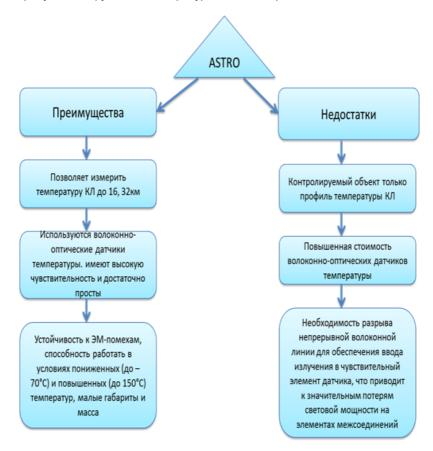
Рисунок 1 – Система температурной диагностики КЛ ASRO
