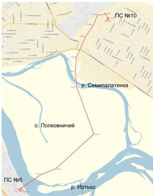
Рисунок 1 – План-схема трассы двухцепной ВЛ 110 кВ от ПС №5 до ПС №10
