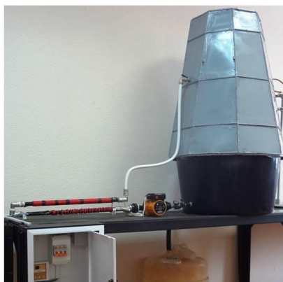
Лабораторный стенд «Установка водооборотного охлаждения – 0,3»
