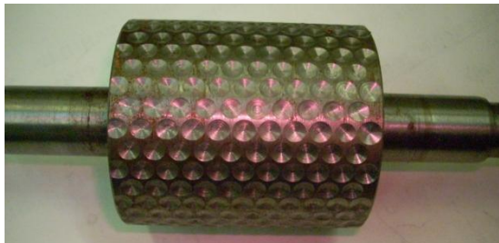
Рис. 2. Объект исследования – ротор со сферическими выемками на его цилиндрической поверхности
