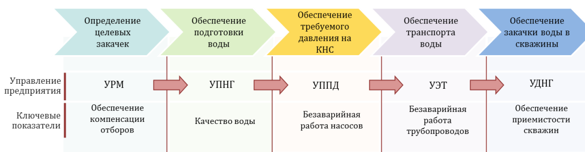
Рис. 1. Схема процессного процесса управления закачкой воды в систему ППД и поглощения
