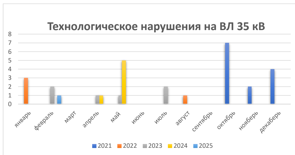
Рис. 1. Технологическое нарушение на ВЛ 35 кВ
