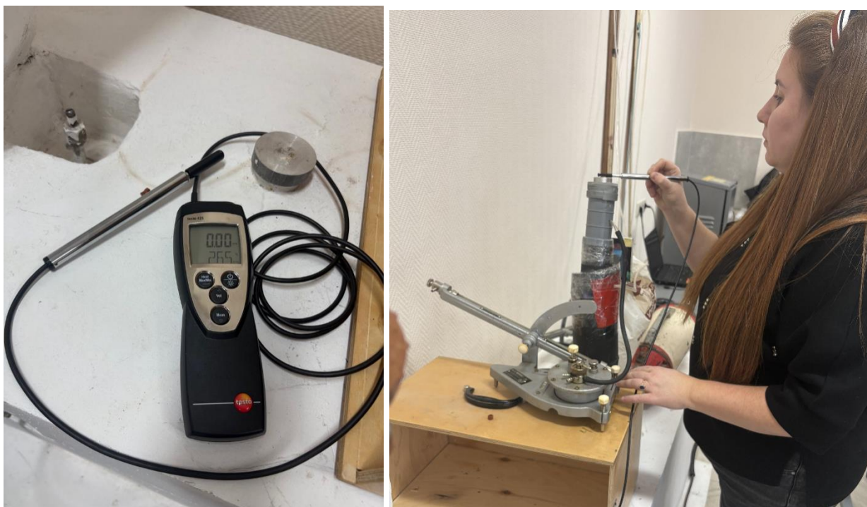
Рисунок 5.4 Измерение скоростей потока в циклоне при помощи термоанемометра Testo 425
