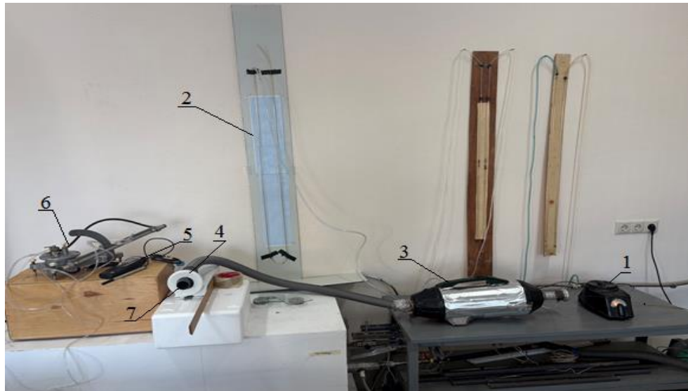
Рисунок Г 2. Схема лабораторной установки для тарировки трубки Пито относительно средней скорости, полученной по термоанемометру Testo 425: 1 – регулятор напряжения; 2 – U-образный манометр для замера статического давления на коллекторе плавного входа (КПВ); 3 – нагнетатель с КПВ; 4 – патрубок для подачи воздуха на вход в циклон; 5 – термоанемометр Testo 425; 6 – микроманометр ММН-2400 для замера разности полного и статического давления на трубке Пито; 7 – тестовая точка в потоке перед входом в циклон
