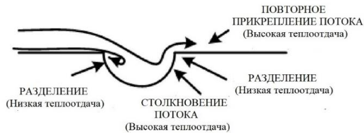
Рисунок 1.1 – Структура отрывного обтекания сферической выемки и механизмы, ответственные за улучшение теплоотдачи [17]
