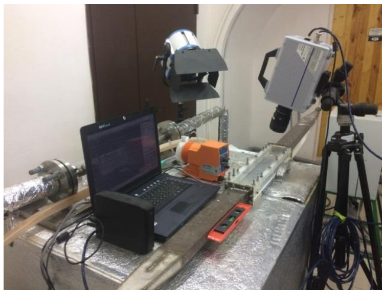
Рисунок 2.2 – Экспериментальная водопроливная установка №1 и рабочий участок для высокоскоростной визуализации течения в канале с одиночными и многорядными системами выемок и определения коэффициента гидравлического сопротивления.
