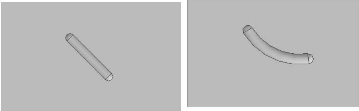
Рисунок 2.10 – Схемы стальных рабочих пластин для тепловизионной визуализации с овально-траншейным и овально-дуговым интенсификаторами
